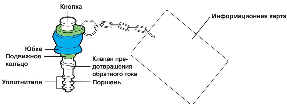
Адаптер для очистки канала подачи воздух/вода, подсоединенный к эндоскопу; очистка сопла и канала подачи воздуха
